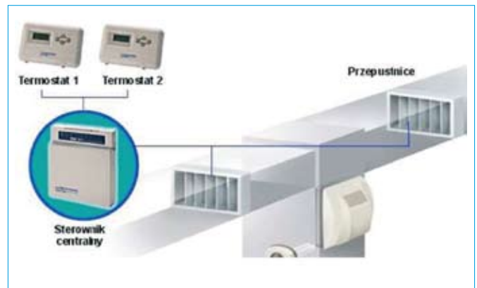
Rys. 1. Prosty układ regulacji klimatyzacji
