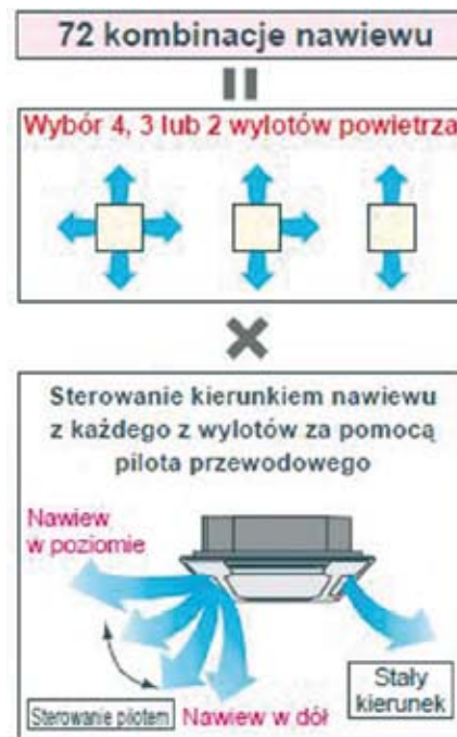
Rys. 5. Kombinacje nawiewu powietrza dla kasetonowej jednostki wewnętrznej [3]
