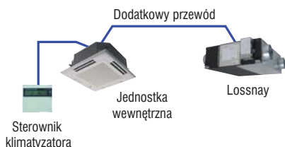
Rys. 4. Schemat ideowy podłączenia klimatyzatora z rekuperatorem Lossnay
